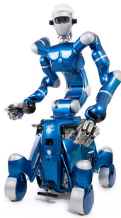
Abbildung 4: Rollin' Justin (DLR) kombiniert einen menschenähnlichen Oberkörper mit einer fahrenden Plattform und muss sich daher nicht aktiv balancieren. Quelle: DLR
