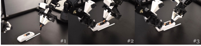
Abbildung 18: Batterie ACT : Einsetzen einer Batterie in eine Fernbedienung. Die Fernbedienung wird entlang einer 15 cm langen weißen Linie zufällig positioniert. Die Rotationen der Batterien werden zufällig festgelegt. Der rechte Arm greift zuerst die Batterie (Subtask #1: Greifen) und setzt sie dann in den Batterieschacht ein (Subtask #2: Platzieren). Der linke Arm drückt auf die Fernbedienung, um ein Verrutschen zu verhindern, während der rechte Arm die Batterie vollständig hineinschiebt (Subtask #3: Einsetzen). Quelle: [43].
