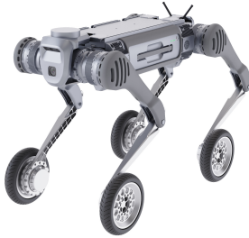
Abbildung 3: Der B2-W (Firma Unitree) hat angetriebene Räder an seinen Füßen und kann so dynamisch zwischen Gehen und Fahren wechseln. Quelle: Unitree
