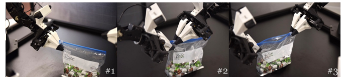
Abbildung 17: Ziploc ACT: Öffnen einer Ziploc-Tüte, welche aufrecht auf einem Tisch steht, mit Hilfe des ACT-Algorithmus. Die Tüte wird entlang einer 15 cm langen weißen Linie zufällig positioniert und aus etwa 5 cm Höhe fallengelassen, um eine zufällige Veränderung von Höhe und Aussehen der Tüte zu erzeugen. Der linke Arm greift zuerst den Körper der Tüte (Subtask #1: Greifen), danach klemmt der rechte Arm den Schieberegler der Tüte ein (Subtask #2: Einklemmen). Anschließend bewegt sich der rechte Arm nach rechts, um die Tüte zu öffnen (Subtask #3: Öffnen). Quelle: [43].
